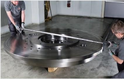
**PAQUÍMETRO EM FIBRA DE CARBONO
