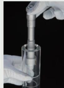
Ideal para medição em furo cego (perto do furo). Com pontas revestidas de titânio com alta durabilidade.
