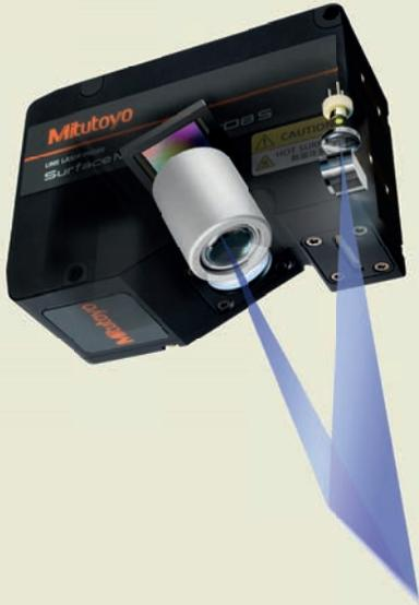
Um conjunto ótico que produz uma linha de laser estabilizada. Este utiliza um comprimento de onda azul o que permite medições precisas em peças reflexivas e até transparentes para que você possa usá-lo imediatamente após a montagem.
